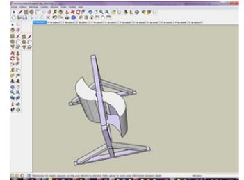
Puis, sur ce dessin déjà réalisé, vous réglerez l'écart entre les pales afin qu'il corresponde à 1/6 du diamètre complet du rotor. Cela vous demandera certainement de redessiner totalement le rotor et d'effectuer quelques petits calculs. C'est pour cela que nous vous demandons de travailler sur la version simple de la SAVONIUS, la version maquette en carton.
