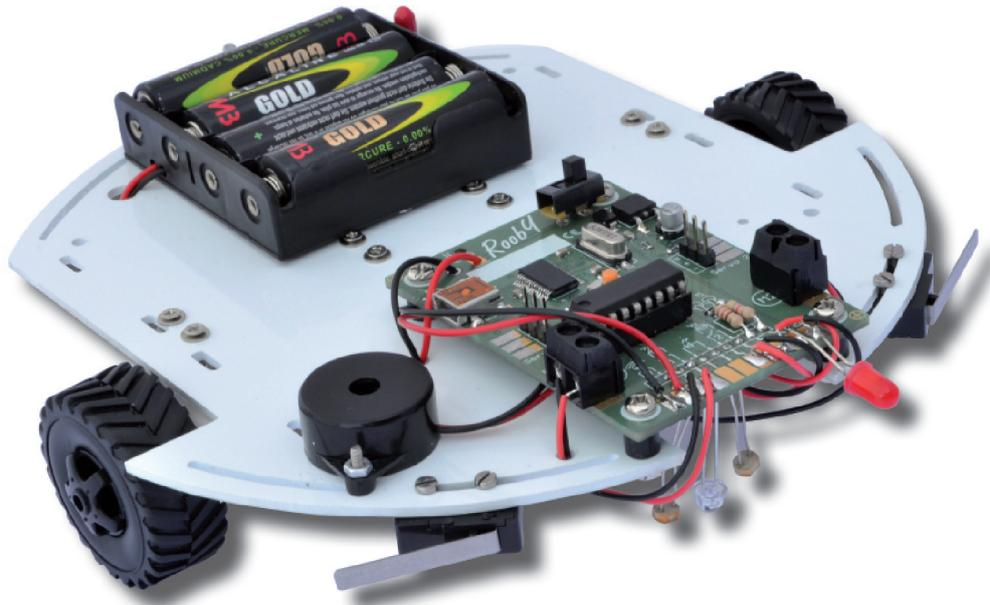
A l'aide du scénario ci-dessous, vous devez créer un programme avec le logiciel RoobyPilot. Le robot possède des servomoteurs, des capteurs fin de course, un buzzer, une LED rouge....
